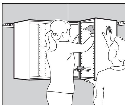
Installer le caisson d'angle en premier. Serrer les vis. Accrocher les caissons suivants et les solidariser à l'aide des vis fournies. Ne pas serrer les vis à fond avant la pose des caissons bas, de manière à pouvoir aligner le tout.
